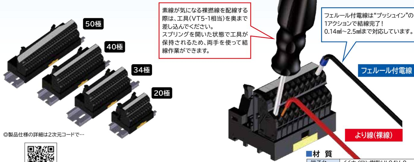
素線が気になる裸線を配線する際は、工具(VT5-1相当)を奥まで差し込んでください。スプリングを開いた状態で工具が保持されるため、両手を使って結線作業ができます。
